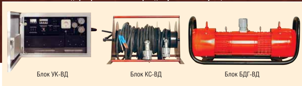
Рис. 11. Мобильный стенд проверки комплектного привода в условиях эксплуатации
