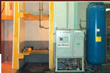
Рис. 4. Боксы стэнда с испытываемыми двигателями и системой охлаждения
